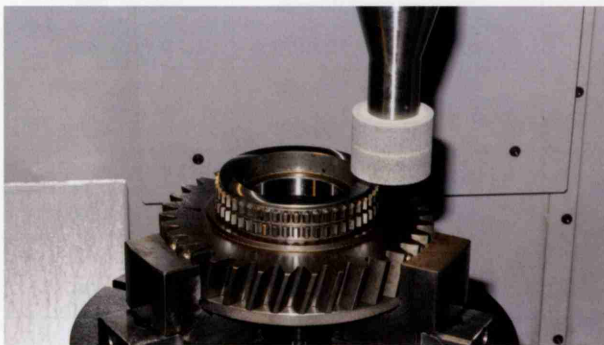
3RD-ギヤ 被削材 <JIS>: SCM420H
